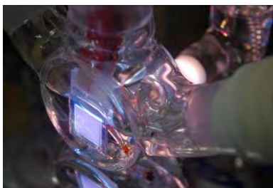
図. 光電気化学セルを用いた水素発生実験
