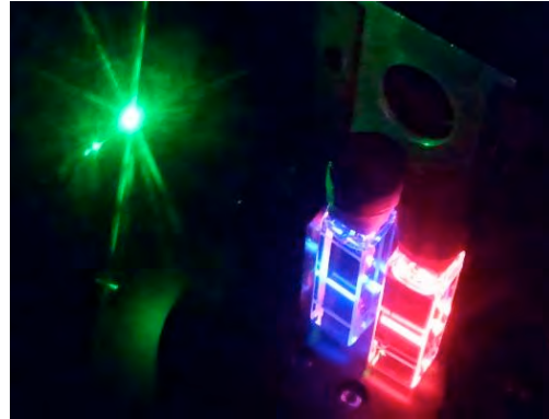
図. ポルフィリンプラチナ錯体とジフェニルアントラセンからなる分子系における三重項-三重項消滅に基づくフォトン・アップコンバージョン
