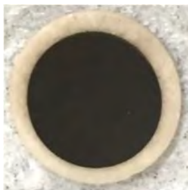
図 1 セラミック電解質を用いて試作した全固体電池
