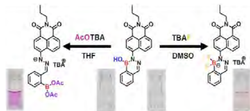
図. 合成されたジアザボリン \pi 共役系化合物のアニオンに対する光学応答
