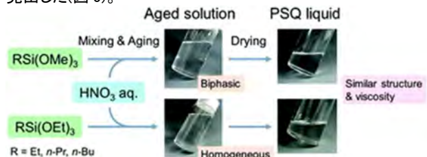
図 4 ポリシルセスキオキサン合成経路。熟成中に液-液相分離が起こらなくとも PSQ 液体が得られる
