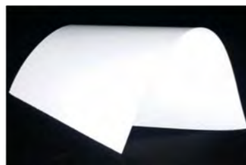
図3 フレキシブルで機械的強度に優れた無機有機コンポジット電解質膜薄膜シート。
