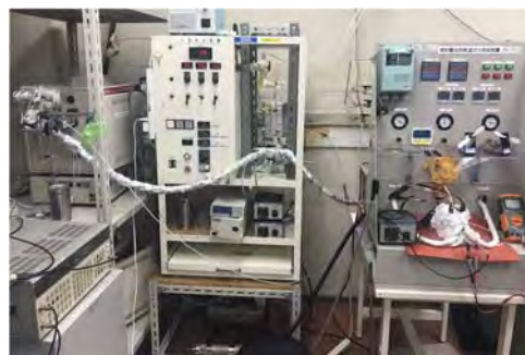
図4 リン酸とイオン液体の混合物からなる新規電解質を用いた燃料電池およびその評価分析システム。
