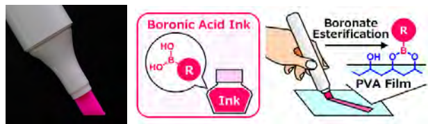
図 6. ボロン酸基を持つ分子インクを充填したマーカーペンを用いたポリビニルアルコール固体表面の機能化.
