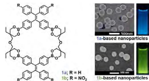
図 4. ボロン酸の動的共有結合に基づくセルフソーティングを通して生成する凝集誘起発光 (AIE) 型大環状化合物。
