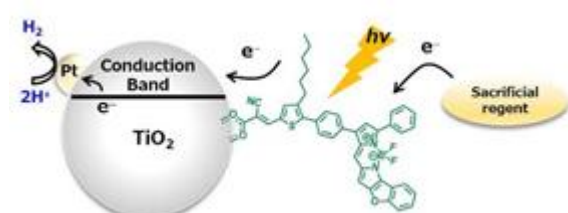
図 1. 光エネルギーを用いて水から水素を製造するための色素増感型光触媒。
