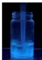
図 3. ナノシートの添加による発光増強の様子
