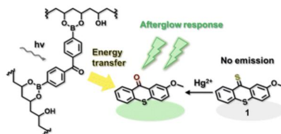
図3. ベンゾイルフェニルボロン酸架橋 PVA を用いた turn-on 型残光材料.
